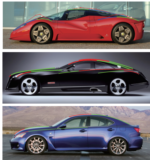
図 5 市販車のキャラクタラインにフィッティングした複合リズム対数型美的曲線。これらの曲線は谷型複合リズム曲線でありその \alpha_0 と \alpha_1 はそれぞれ -0.1 と 0.1 を用いている。最も上の例では、入力に用いた制御点とそれらを結ぶ線とともに第 1 と第 2 セグメントをそれぞれ緑と青で描いている。他の 2 つの例では、それらを赤と緑で描いている。
